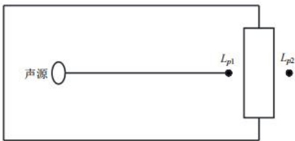
图 4-2 室内声源等效为室外声源图例
