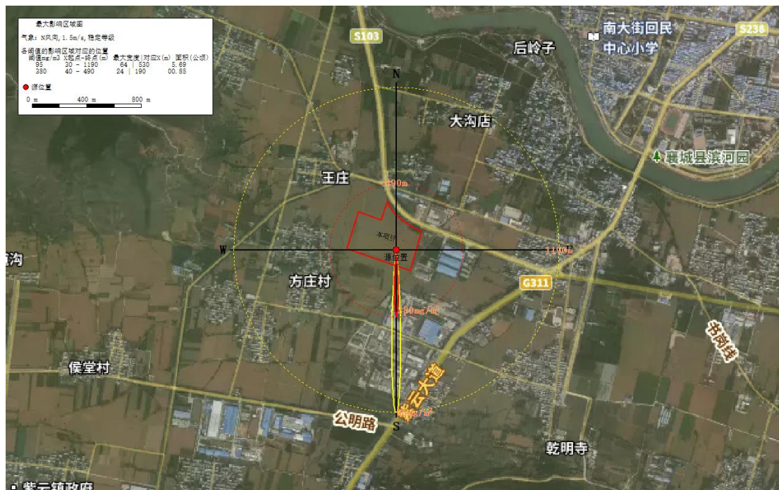
图 9-5 CO 达到不同毒性终点浓度的最大影响区域图（稳定度 F）
