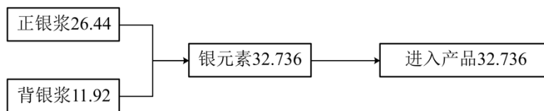
图 2.3-15 银元素平衡图 (单位: t/a)
